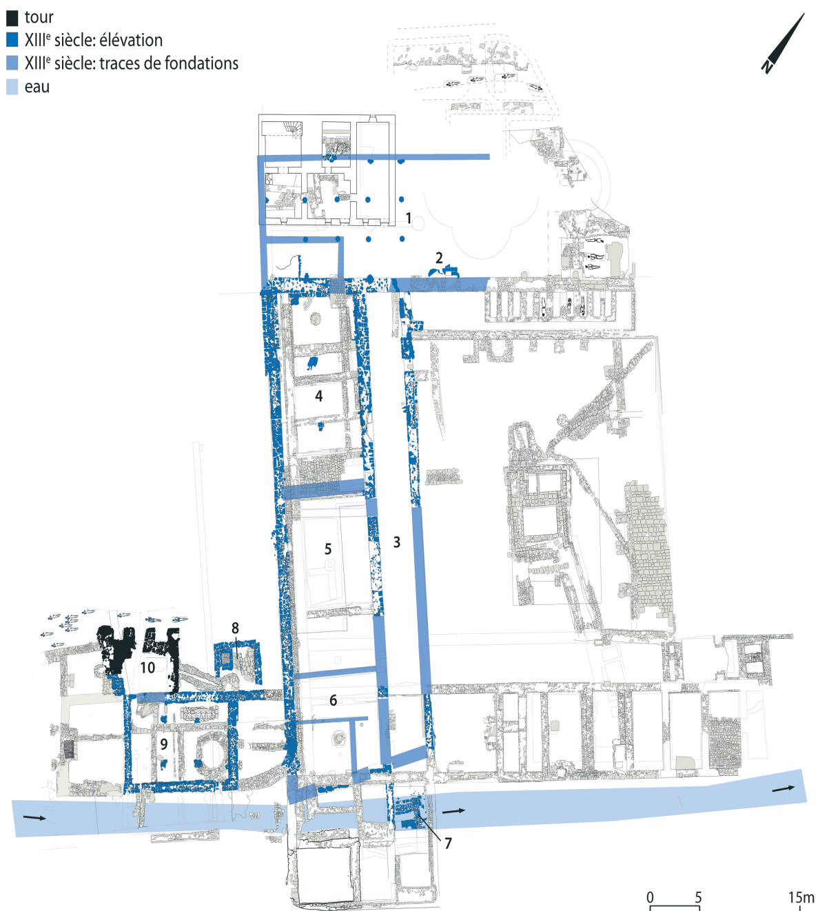
Fig. 4 - Clairefontaine I, plan de l'abbaye au XIII e siècle et essai d'identification des fonctions (D. Herremans, topographie D. Bossicard, ©SPW-DPat). 1 : nef de l'église et bases des colonnes portant la tribune ; 2 : fontaine Saint-Bernard ; 3 : galerie de cloître ; 4 : salle capitulaire ; 5 : salle de travail ; 6 : réfectoire ; 7 : latrines ; 8 : annexe de la cuisine ; 9 : cuisine avec foyer central ; 10 : tour antérieure à l'abbaye, intégrée au bâtiment de la cuisine.
